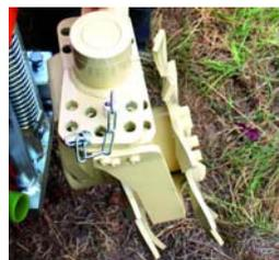
Les disques émotteurs BRAUN peuvent être réglés **sans outil** dans leur angle d'attaque. Suivant cet angle, l'effet de labour est plus ou moins agressif. Grâce à l'épaisseur de matière de 8 mm, les disques étoilés sont particulièrement robustes.
