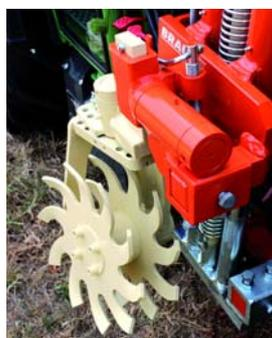
La posición desplazada de las dos estrellas hace que se introduzcan permanentemente durante el movimiento giratorio, con lo que se garantiza una marcha especialmente silenciosa. El grosor del material de 8 mm hace que las estrellas sean especialmente robustas y resistentes a la retorsión.
