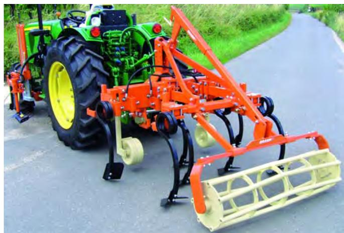
**Cultivador *Vario* con púas flexibles, ruedas de apoyo y rodillo de tambor con suspensión de tres puntos para un mejor control de la profundidad**
