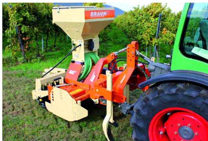
**Cultivador *Vario* con hojas de arado y eje de reja para chisel en combinación con grada rotativa y sembradora**
