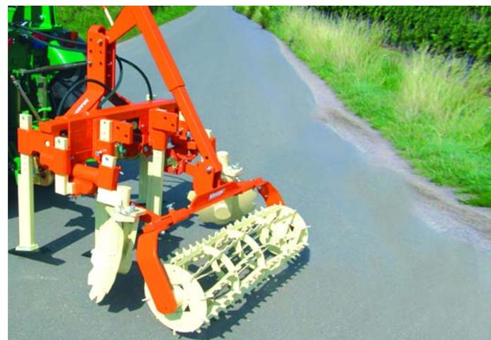
**Châssis modulaire *Vario* court, équipé de socs à pointe mobile, de charrues à disques crantés et d'un rouleau émoteur**
