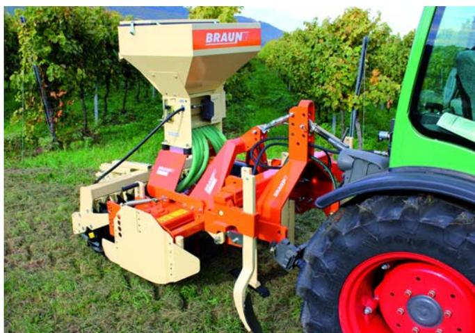
**Le châssis modulaire *Vario*, équipé de corps de charrue et socs à pointe mobile combiné à la herse rotative avec semoir**
