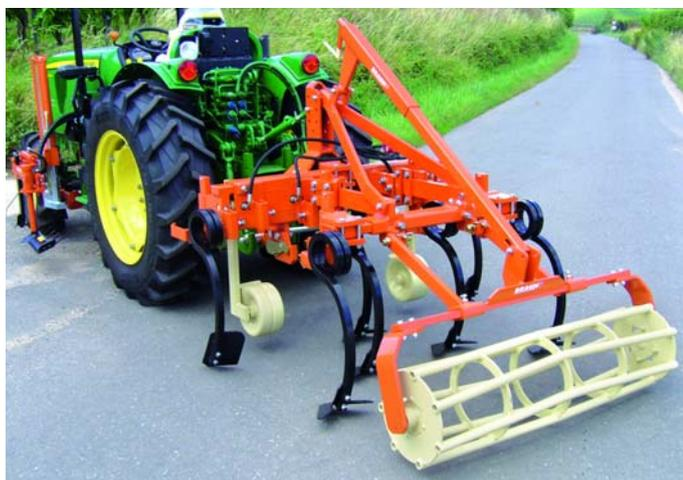
**Châssis modulaire *Vario*, équipé de dents à ressort, roues de terrage et attelage du rouleau dudgeon pour régler la profondeur de travail**
