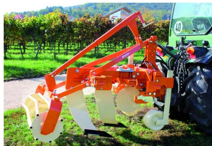
**Le châssis modulaire *Vario*, équipé d'un disque trancheur, de deux dents sous-soleuses, de roues de terrage et du rouleau dudgeon pour réappuyer la terre**
