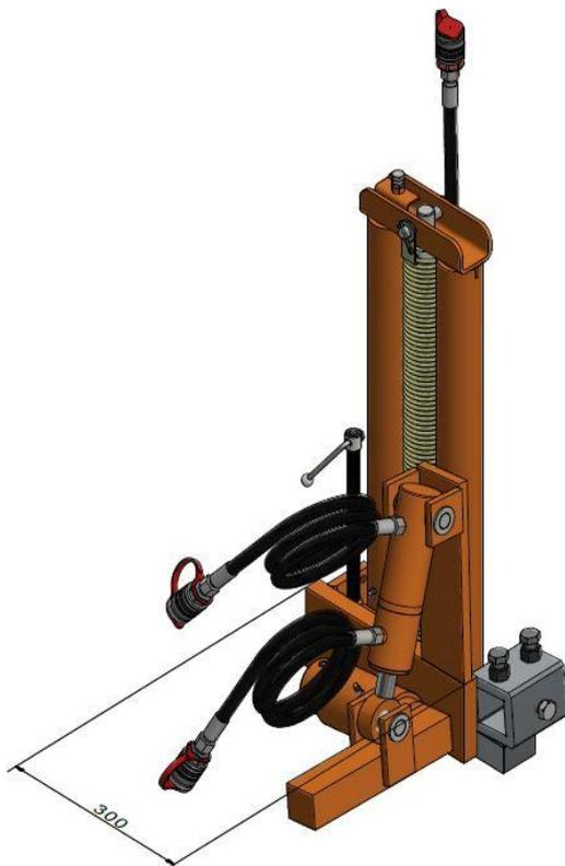
Porte-outils à mouvement vertical précis EW avec réglage de la pente latérale hydraulique et ressort de rappel
